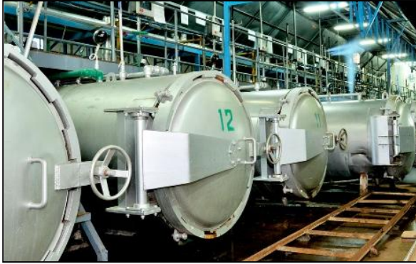
Gambar 5. Proses sterilisasi ikan kaleng dalam retort
