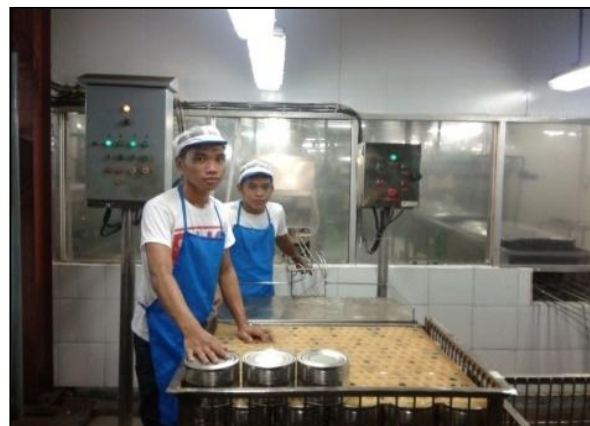
Gambar 4. Penyusunan ikan kaleng dalam basket sebelum disterilisasi
