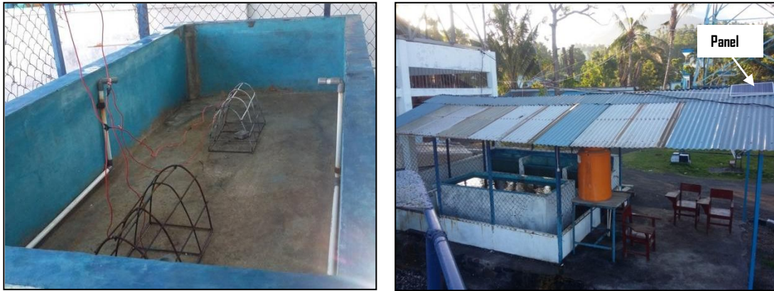
Gambar: 04. Desain prototype kerangka besi sebagai struktur biorock
