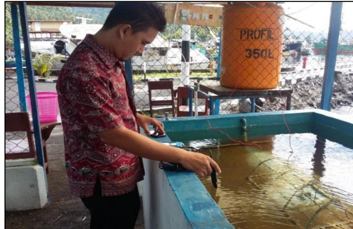
Gambar 06. Pengukuran parameter fisik kimia air laut dalam bak pengujian
