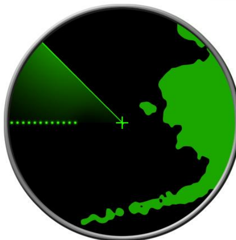
Gambar 1. SART dengan kode 12 titik blip
