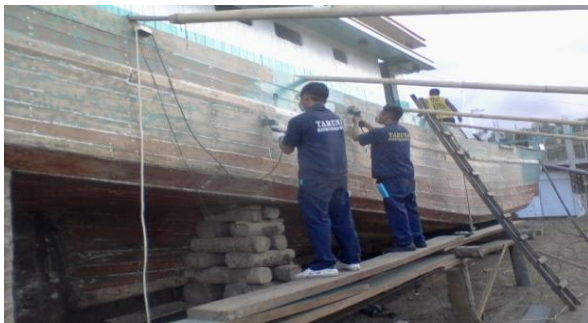
Gambar 9. Pembersihan/Gerinda lambung kapal
