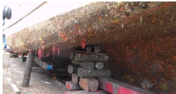
Gambar 7. Biota Laut yang Menempel di Lambung Kapal
